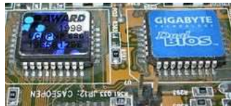
Рис. 2.11. Основная и дублирующая микросхемы ПЗУ материнской платы фирмы Gigabyte. На ПЗУ содержится код BIOS, созданный фирмой Award
