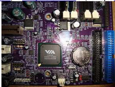
Рис. 2.6. Южный мост VIA 8235
