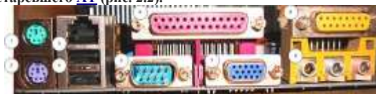
Рис.2.2. Наружные разъемы материнской платы формата ATX
