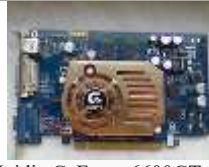
Рис. 2.10. Видеокарта Nvidia GeForce 6600GT (производитель Gigabyte )
