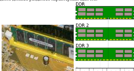
Рис. 2.8. Ключ-выемка на модуле и защёлки на разъёме препятствуют некорректной установке модуля памяти
