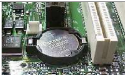
Рис. 2.14. Батарейка CR2032 на материнской плате
