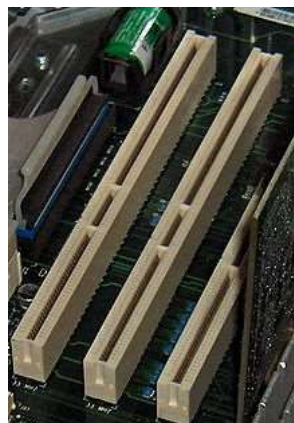
Рис. 2.9. Слоты расширения 64-разрядной шины PCI
