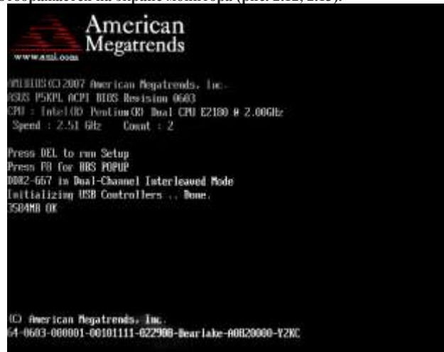
Рис. 2.12. Первый этап типичной операции POST (AMI BIOS)
